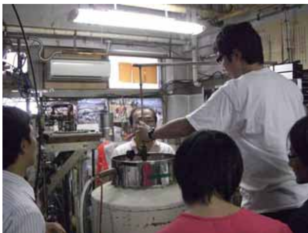
「低温装置と温度計測」のクライostatに液体ヘリウムを移送している様子。奥は担当の石川教授。
