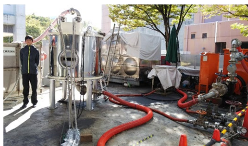
図1 ボア径φ400mm超電導磁石を用いた火力発電所ボイラースケール除去の大型実験装置
