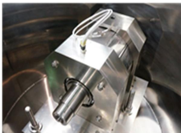
図 3 20 kW 級 HTS-ISM の外觀写真<sup>3,4)</sup>
