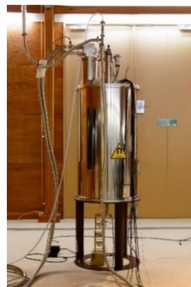
図2 永久電流運転を実証したNMR (理化学研究所に設置)
