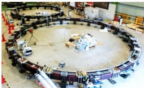
図 2 JT-60SA 用 平衡磁場コイル
