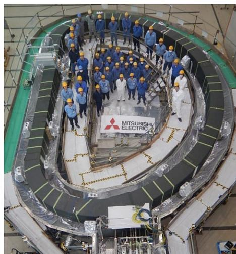
図 4 ITER TF コイル巻線部
