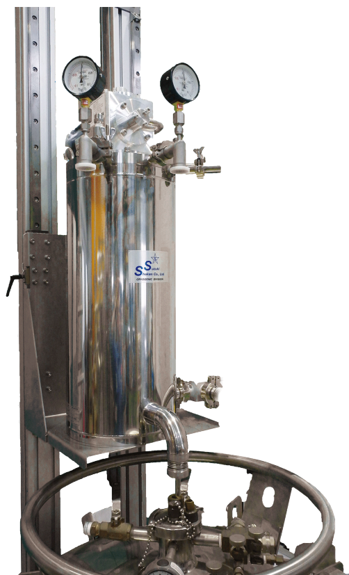
写真 2.ヘリウム再凝縮装置
